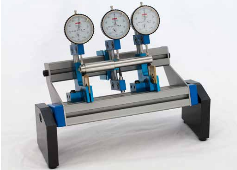
Vertikaler Pendelhalter zum Prüfen von mehreren Durchmessern
